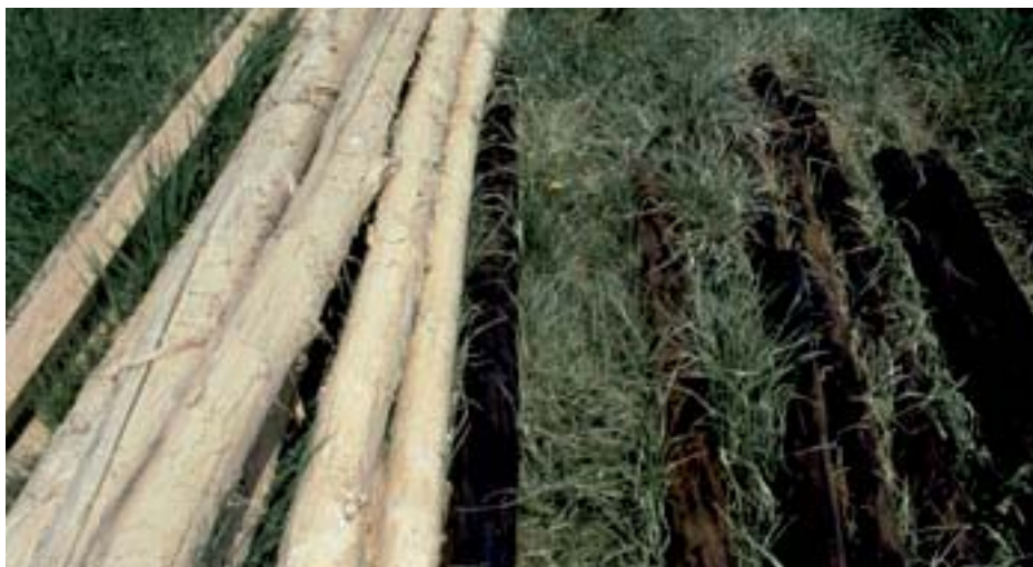
Unimprägnierte Robinienpfähle (links) verursachen im Gegensatz zu teerölimprägniertem Pfahlmaterial (rechts) keine Pflanzenverbrennungen (Grasentwicklung zwischen den Pfählen beachten).
