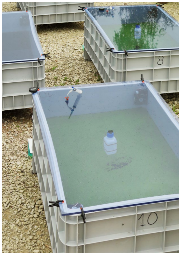
Temperaturmessung und Säurefalle zur Messung der Ammoniakemissionen in einer Wasserlinsenbox mit transparentem Deckel.
